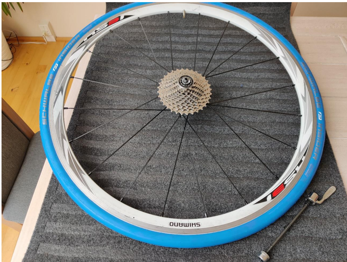
Figur 5: Baghjul med aftaget Quick release aksel
